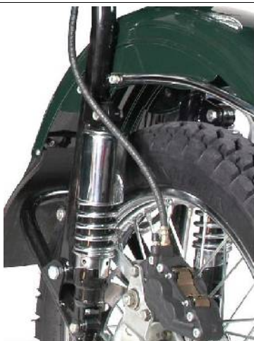
Kit de modificación freno tambor a freno de disco para Earles: 1105 €
