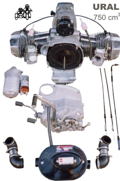
MODIFICACIÓN A ARRANQUE ELÉCTRICO
