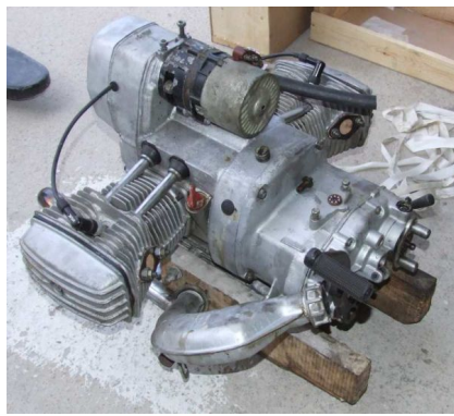
MOTOR CON CAJA DE CAMBIOS DNEPR 650cc
